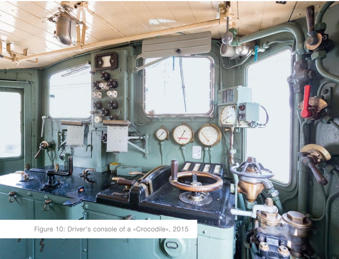
Figure 10: Driver's console of a «Crocodile», 2015
